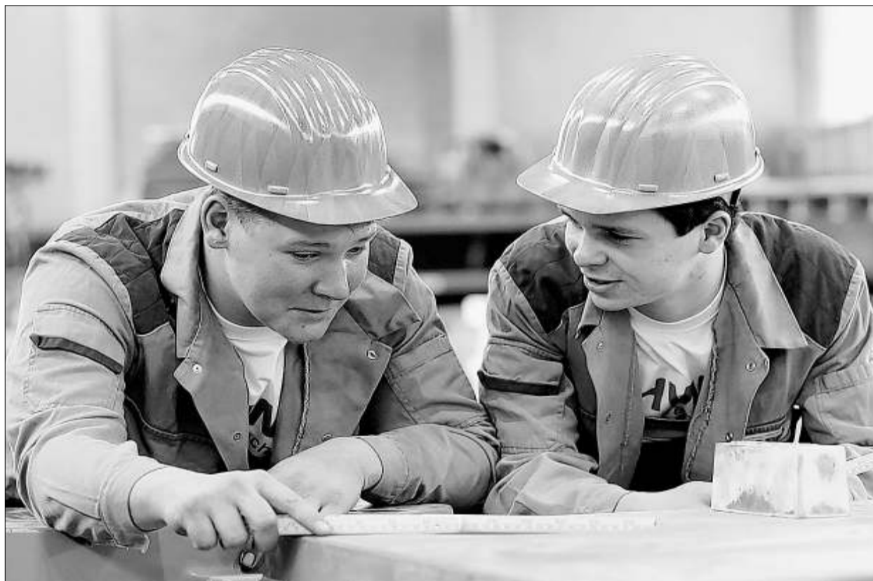
Die beiden SHW-CT-Lehrlinge Philipp Mettmann (links) und Peter Zillich vermessen ein Modell für Sandformen. Firmenfoto
