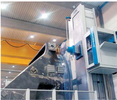
Bearbeitung eines Maschinenträgers auf der PAMA-Fräsmaschine.
