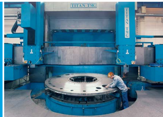
Bearbeitung einer Pitchplatte auf der Karusselldrehtmaschine.
