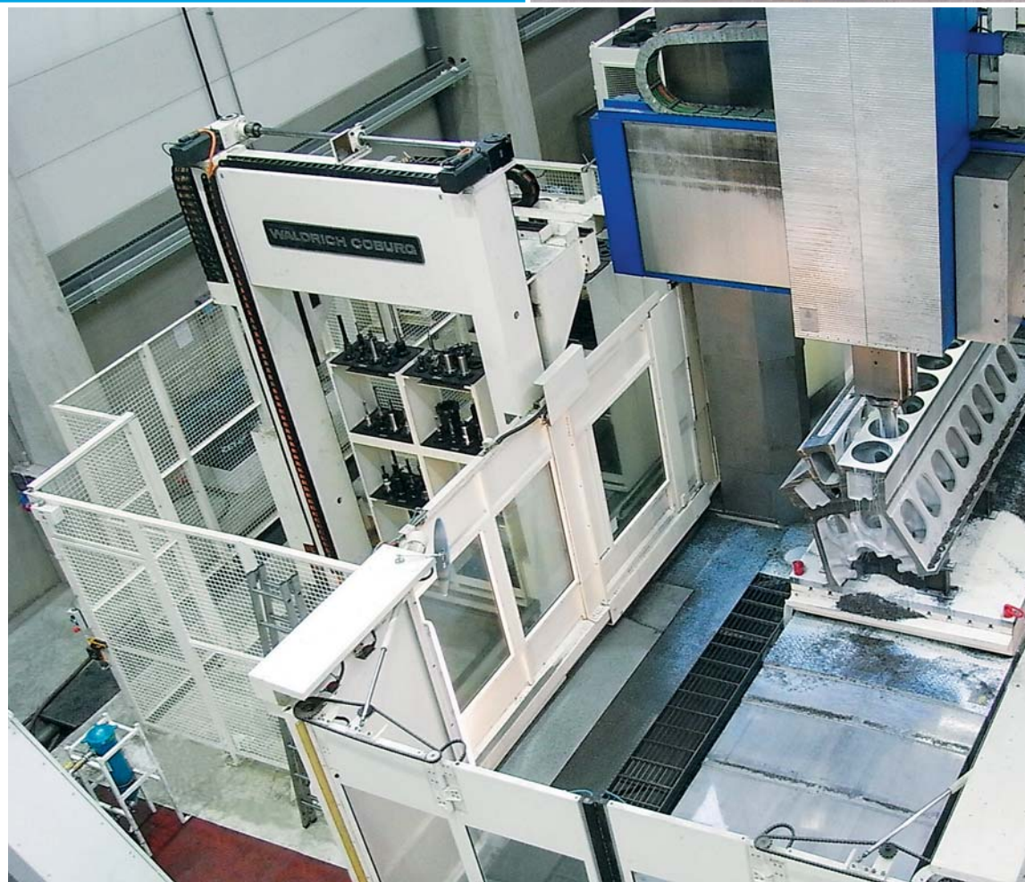
Bearbeitung eines Lokomotivmotorblocks auf der Waldrich Coburg MultiTec-Portal Drehfräsmaschine.
