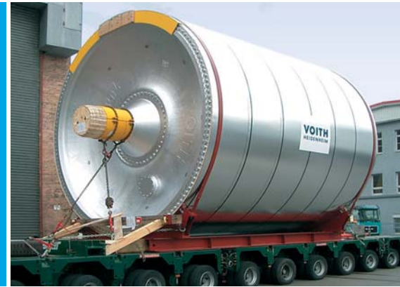
Yankee-Zylinder für Tissue-Papiermaschine (150 t).
