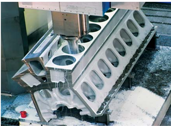
Der Lokomotivmotor wird auf der Portalfräsmaschine bearbeitet.
