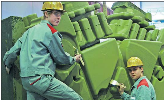
Die SHW-Azubis Steffen Hentschke und Julian Kopke beim Schlichten eines Sandkerns für ein Schiffsmotorengehäuse.
