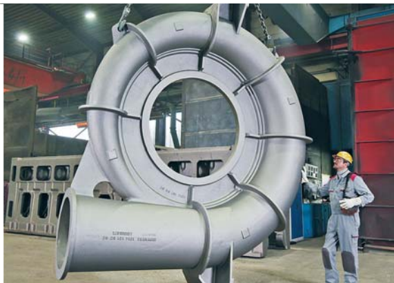
Spiralgehäuse für Radialdampfturbine Ø 4.250 mm.
