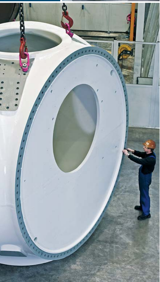
Windkraft-Nabe für 5 MW-Offshore-Anlage (40 t), einbaufertig bearbeitet. Maße: 3.947 x 3.533 x 4.040 mm Werkstoff: EN-GJS-400-18U-LT
