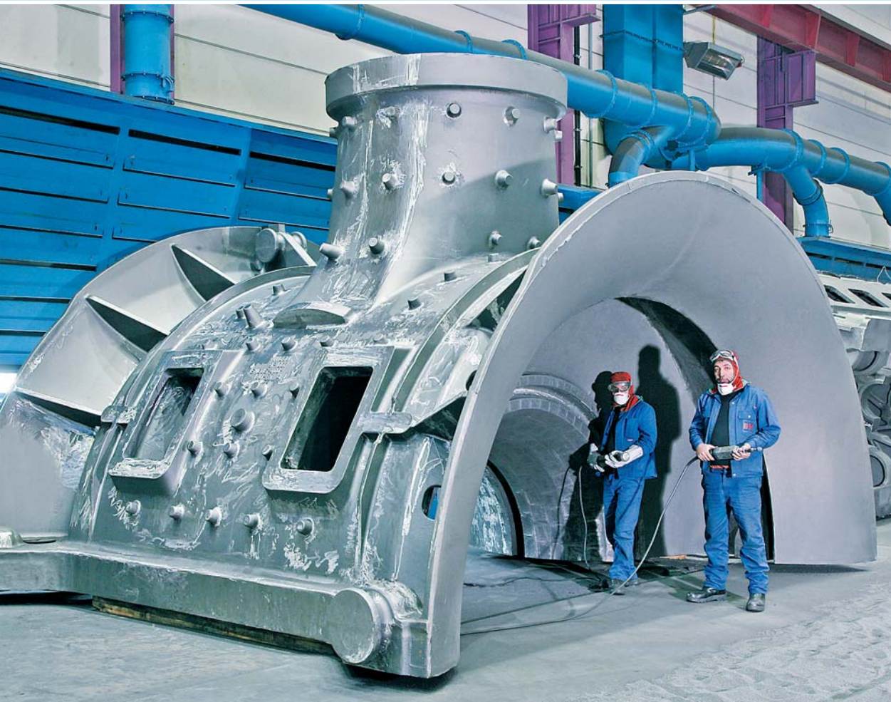
Niederdruckdampfturbinengehäuse (Oberteil) für Turbine mit 800 MW Leistung (52 t). Maße: 4.775 x 6.120 x 3.800 mm Werkstoff: EN-GJS-400-18
