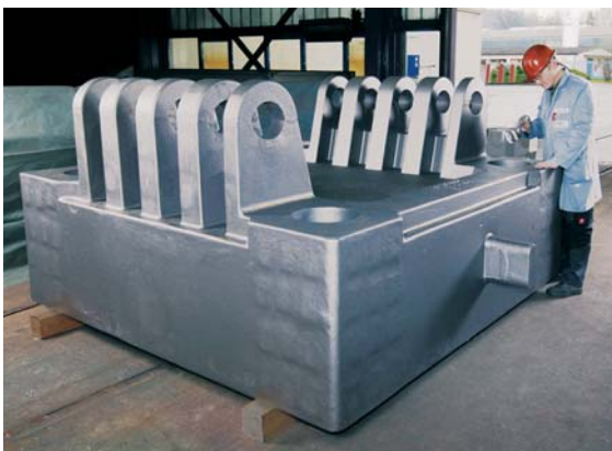
Bewegliche Werkzeugaufspannplatte für Metallspritzgießmaschinen (32 t).
