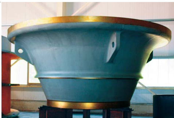
Mahlschüssel für Clinkermühlen (105 t), fertig bearbeitet.
